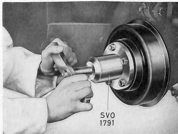
Bild 8. Demont. av nav.
